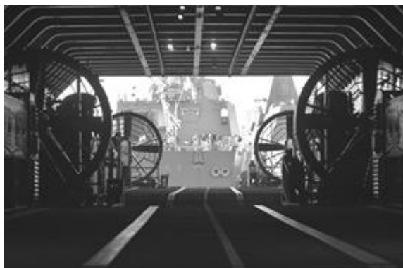
●輸送艦「くにさき」の艦尾には輸送用 エアクッション艇 エルキックが搭載されている。
