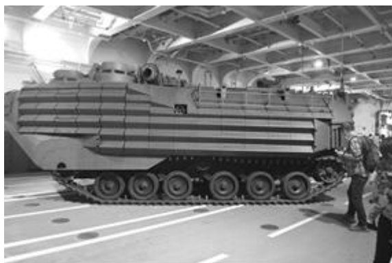
●「くにさき」に搭載されている水陸両用車 AAV7。無限軌道車だが勿論水の上に浮かぶ。
