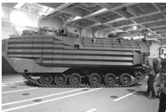
●「くさき」に搭載されている水陸両用車 AAV7。無限軌道車だが勿論水の上に浮かぶ。
